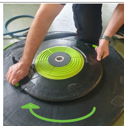
Visser le coussin sur le connecteur
