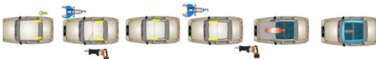
Réaliser une première coupe à l'aide de la cisaille
