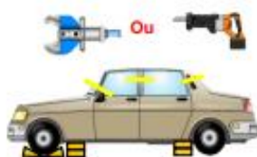
Découpe du pavillon en suivant le marquage
