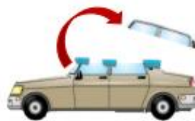
Retrait du pavillon vers la zone déchet - mise en place des protections de coupe
