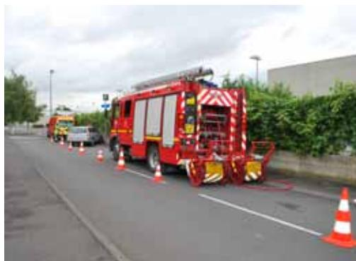
► Il poursuit avec un balisage de raccordement en biseau, un balisage d'approche longitudinal réalisé avec les cônes de lubeck
