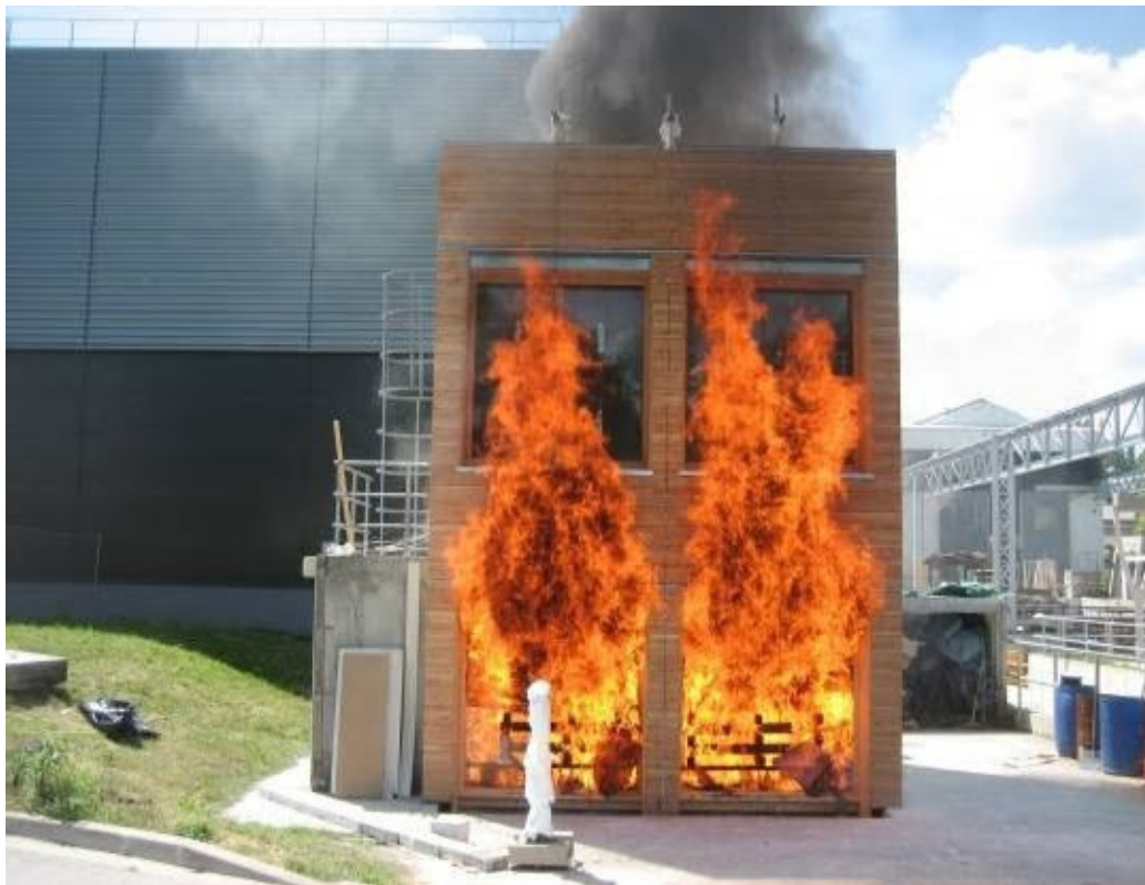
Photo n°6 : Surface en feu Extinction directe
