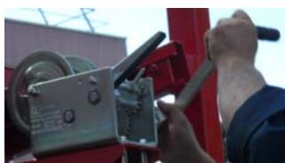
A l'aide de la manivelle, détendre légèrement le câble du treuil. (répéter pendant la descente si nécessaire)
