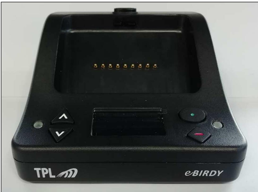
Le support eBirdy est un programmeur/flasheur à distance pour les appareils sélectifs Birdy WP de TPL Systèmes. Il permet à distance la mise à jour des versions logicielles et de la personnalisation des appareils sélectifs.
