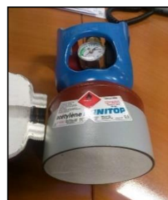
Coupe de bouteille d'acétylène permettant de visualiser la matière poreuse
