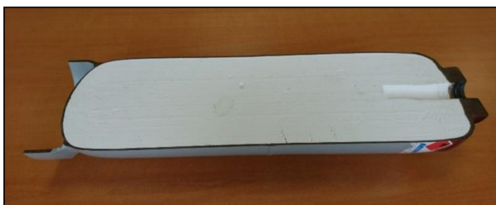
Coupe de bouteille d'acétylène permettant de visualiser la matière poreuse
