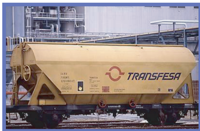
Wagon pour le transport d'engrais au nitrate d'ammonium et de matières pulvérulentes (hydroxyde de sodium solide, ...)
