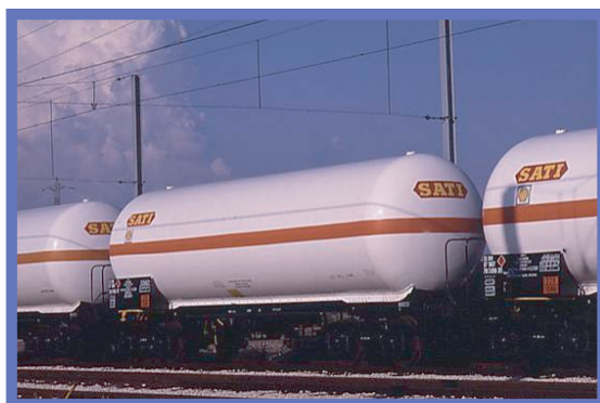
Wagon citerne pour le transport de Gaz réfrigéré Liquéfié ou dissous
