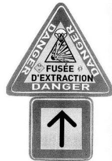
Localiser l'emplacement de la roquette et son sens d'extraction, en recherchant les éléments de signalisation collés sur le fuselage de l'ULM.
