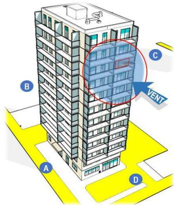
Si une telle veine d'air passe par le foyer, non seulement les gaz de combustion suivront cette veine d'air avec une vitesse qui peut être élevée, mais la sur-ventilation du foyer accroîtra notablement la puissance de celui-ci et la production de gaz chauds qui en résulte.
