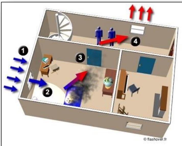
Il y a un feu dans un local dont au moins 1 ouvrant donne sur une façade au vent. Celui-ci va fournir du comburant en quantité plus que nécessaire et contrarier la sortie des fumées et des flammes. Il se produit une surpression dans le local.
