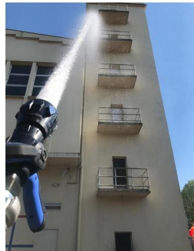
**Attention !!! L'utilisation d'une lance en jet diffusé pour cette technique d'application d'eau n'aura aucun effet, au contraire, cela risque de bouchonner la sortie des fumées.**
