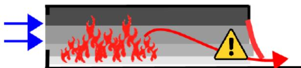
Le rideau se déplace **vers l'extérieur**. Cela signifie qu'il est positionné au niveau d'un **sortant**. Des **fumées peuvent sortir** sous le stoppeur de fumées.
