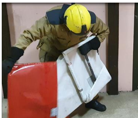
Sortir le stoppeur de fumées de son sac de transport en le saisissant par la barre
