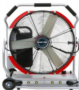
Le LEADER E-Fan 18" électrique sur batterie peut être positionné à une distance de l'entrant allant **de 0,90 m à 7 mètres** (distance optimale de 3 m à 6 m) avec une inclinaison d'environ 10°.
