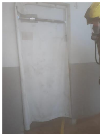
Recloisonnement du feu par l'installation d'un stoppeur de fumées
