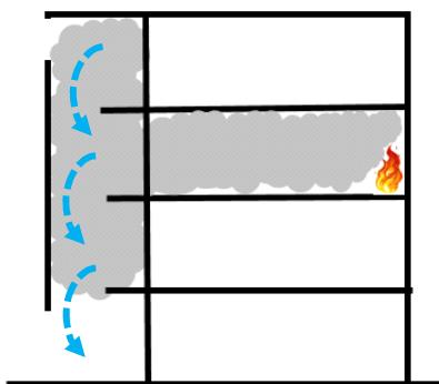
Lorsque l'été, un bâtiment doté d'un système d'air conditionné génère un mouvement de l'air du haut vers le bas, s'opposant ainsi à l'élévation des fumées.
