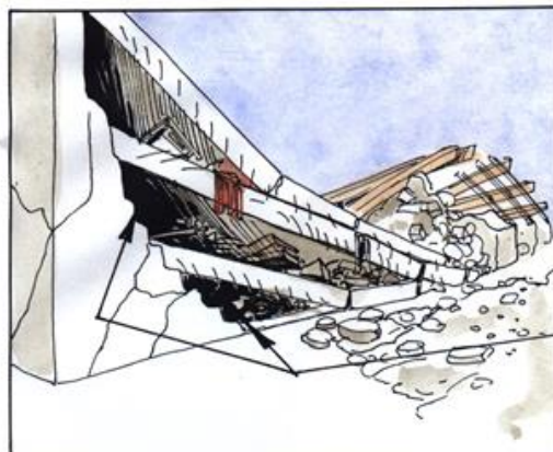
EFFONDREMENT EN OBLIQUE
